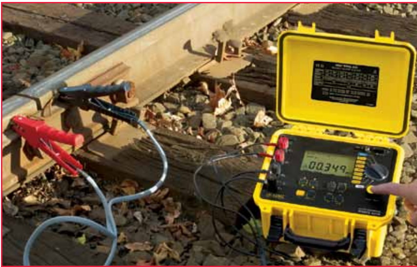
Verificación de uniones de rieles con el Modelo 6250
